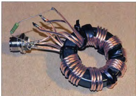
Bild 9: Fertig gewickelter Unun für drei Übertragungsverhältnisse
