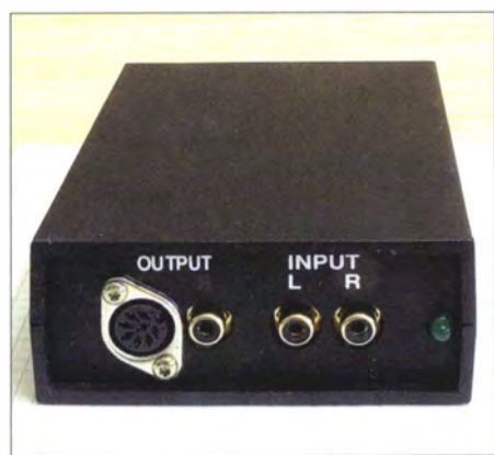
Bild 1: Die DIN-Buchse am Audio-Trigger dient lediglich zur Spannungszuführung.
