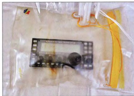
Bild 3: Diese regendichte Plastiktüte mit Zipp-Verschluss schützt den KX3 zuverlässig und könnte auch noch ein Logbuch aufnehmen.
