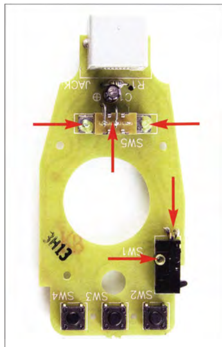
Bild 3: Schiebeschalter (oben) und PTT-Mikrotaster (unten rechts) lassen sich relativ einfach von der Originalplatine ab- und sogar ggf. wieder zurückbauen. Die Pfeile deuten auf die Befestigungspunkte und die Lötstellen.
