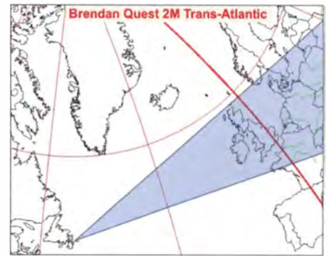
Diesen Winkel deckte die 43-Element-Yagi-Antenne bei VC1T ab; sie war praktisch exakt zu G4SWX ausgerichtet. Grafik: VC1T
