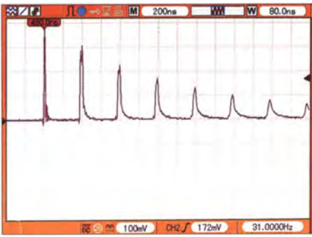
Bild 16: Mehrfachreflexionen an 15 m Koaxialkabel; Kabelende offen
