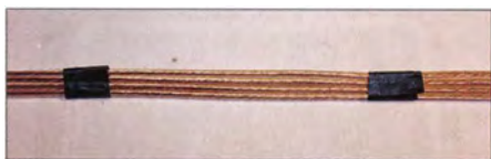
Bild 8: Mit Isolierband lassen sich die Drähte einer quadrifilaren Wicklung vor dem Aufbringen auf dem Ringkern fixieren.
