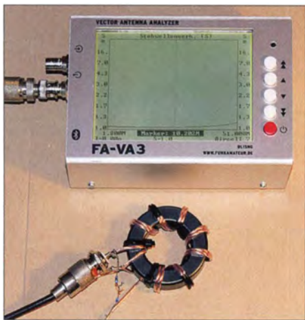
Bild 7: Messaufbau mit Antennenanalysator FA-VA 3 und 1:4-Balun
