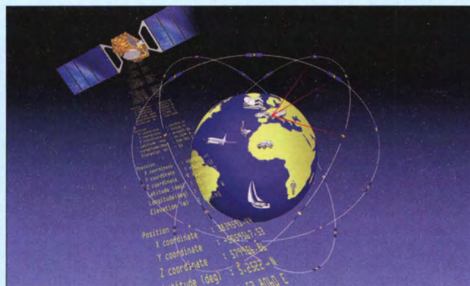
Bild 5: Ein solches satellitengestütztes, globales System zur Positionsbestimmung liefert die für APRS benötigten Daten. Diese werden vom GPS-Modul empfangen, aufbereitet und über die serielle Schnittstelle an den APRS-Tracker übertragen.
