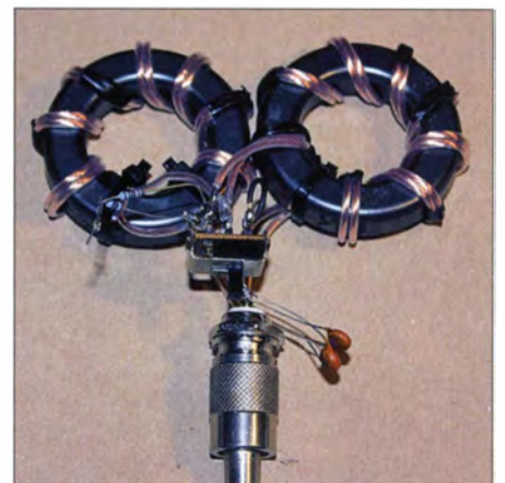
Bild 19: Musteraufbau des umschaltbaren Baluns gemäß Bild 18 Fotos: DK7ZB
