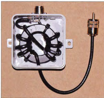
Bild 1: Praktische Ausführung des W1JR-Baluns in einer Installationsdose
