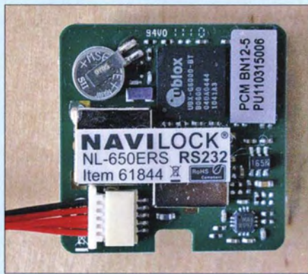
Bild 6: Ein GPS-Modul, wie z. B. das Navilock NL-650ERS, ist für den APRS-Betrieb unbedingt erforderlich. Es überträgt die ermittelten eigenen Positionsdaten über eine serielle Schnittstelle zum APRS-Tracker.
