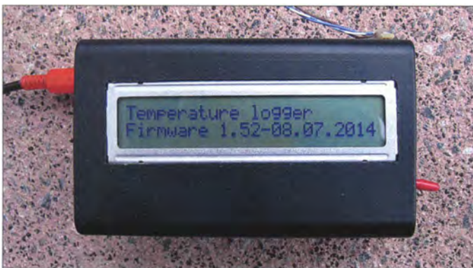
Bild 2: Ansicht des auf einer Lochrasterplatine realisierten Datenloggers mit der integrierten I 2 C-USB-Bücke Fotos: Cina
