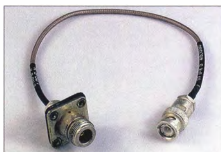
Bild 3: Eine N-Flansch-Kabelbuchse mit fertig konfektioniertem PTFE-Koaxialkabel erspart Arbeit. Das Kabel reicht für eine 70-cm-λ/4-Drossel. Der BNC-Stecker bleibt übrig.
