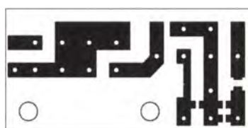
Bild 14: Layout der HF-Platine; Abmessungen 46,2 mm × 22,8 mm, M 1:1; die Layouts sind auf www.funkamateurl.de verfügbar.
