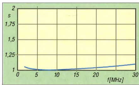
Bild 17: Anpassungsverhalten des umschaltbaren Baluns bei einem Verhältnis von 1:4
