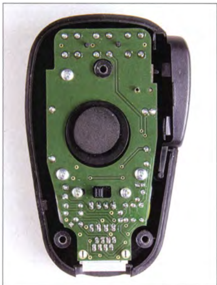
Bild 1: Austauschplatine mit Roger-Piep-Funktion im geöffneten Mikrofongehäuse
