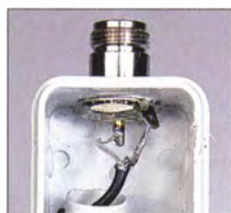
Bild 4: Schlechtes Beispiel; die runde N-Buchse dreht sich u. U. mit; ferner sind die Anschlussdrähte für 70 cm ungünstig lang.
