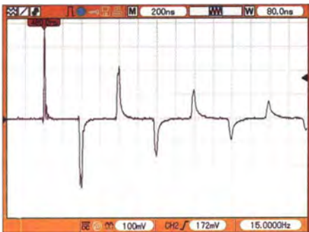
Bild 19: Mehrfachreflexionen an 15 m Koaxialkabel; Kabelende kurzgeschlossen
