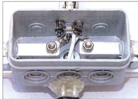
Bild 9: Neue Anschlussdose der 7-Element-Yagi nach [5]; die Enden der Halbwellenumwegleitung sind auf kürzestem Wege ange-lötet. Fotos: DK7ZB (1), DL3VL (1), Red. FA
