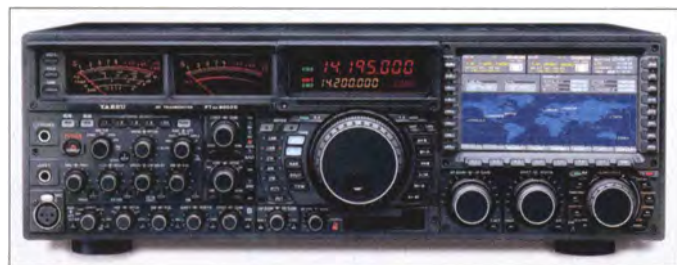
Bild 1: Moderne Transceiver wie dieser Yaesu FTdx9000 zeigen herstellerübergreifend zu Sendebeginn Verhaltensauffälligkeiten im Millisekundenbereich, die es im Einzelfall zu beachten gilt. Werkfoto
