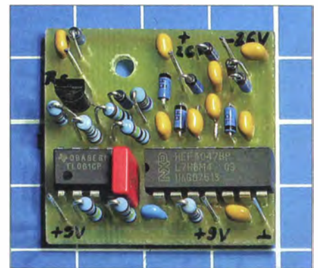
Bild 21: Ansteuerplatine; alle Widerstände wurden stehend eingelötet.
