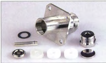
Bild 8: N-Flansch-Kabelbuchse mit rückseitiger Verschraubung für RG174-, RG188- oder RG316-Koaxialkabel, Fabrikat Telegärtner, Artikel-Nr. 11531 bei [7]
