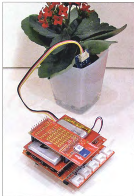
Beispiel einer Anwendung am TI-Stand: Sensoren für Feuchtigkeit, Temperatur und Licht überwachen die Umweltbedingungen.
