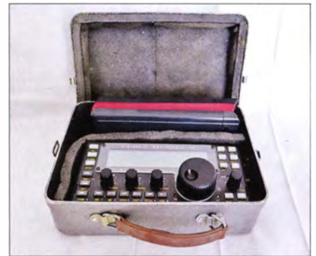
Bild 4: Aluminiumschutzbox des russischen Vielfachmessers Z4313, hier mit einem KX3 sowie einem zusätzlich eingerichteten Fach Fotos: DH6RD
