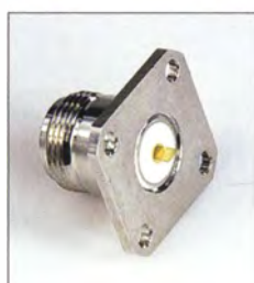
Bild 5: Die N-Einbaubuchse mit 4-Loch-Flanschbefestigung (N-BU-FL im FA-Leserservice) hat eine sehr kurze Lötfläche am Mittelstift und erlaubt so sehr kurze Leitungsführung.
